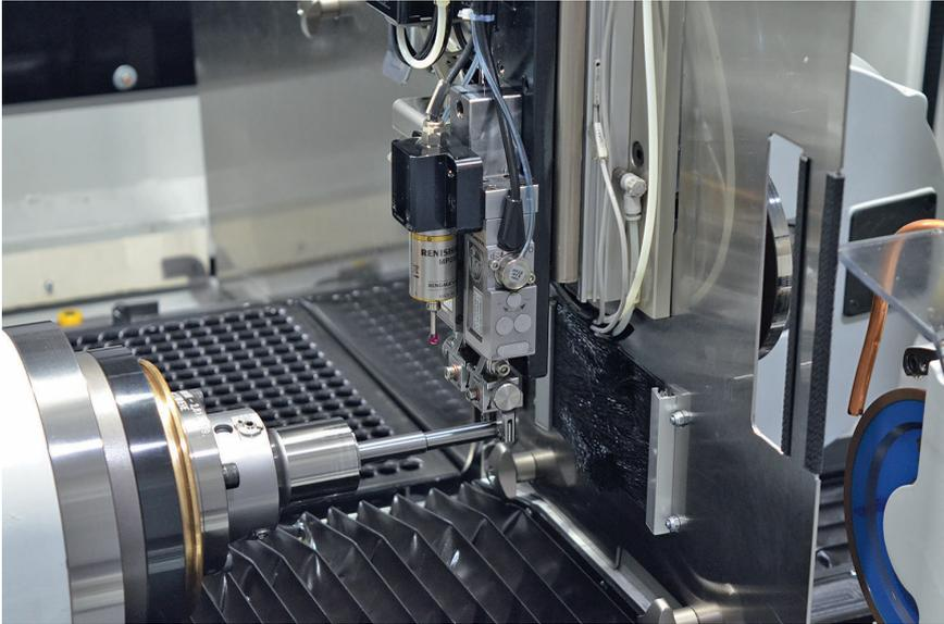
3 Rohlingsbearbeitung für Großserienansprüche: integrierte, gesteuerte In-Prozess-Messung macht es möglich © Anca
